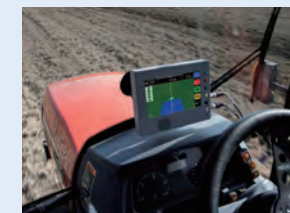
トラクターに装着する 直進自動操舵補助装置
