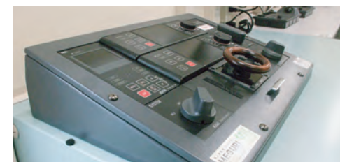
無人運航船の実験船に搭載された当社製オートパイロット
